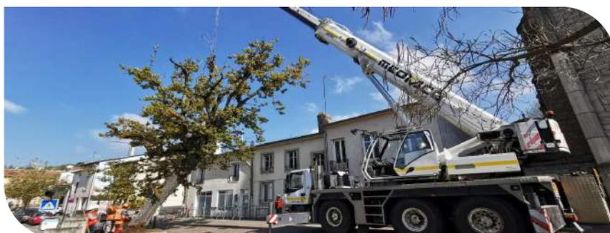
Un test de traction a été réalisé afin d'expertiser l'état du Chêne de la Liberté au Village auquel les Laxoviens sont tant attachés. L'objectif est d'assurer que l'arbre puisse être conservé le plus longtemps possible sans risque pour la sécurité des biens et des personnes.
